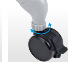
高さ調整機能付 キャスター上部のリングを回転させることによりレベル調整が可能です。(最大+10mm)
